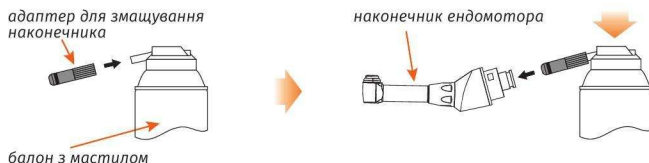
Рис. 12 Змащування наконечника
